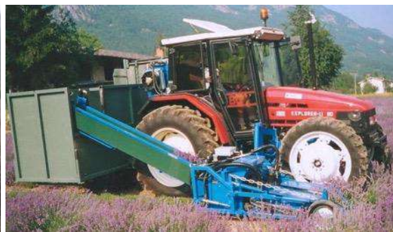
Imatge 19: recol·lectores en feixos (esquerra) i de planta sencera dreta de la marca Ponzo SARL. Foto: Ponzo-sarl.
