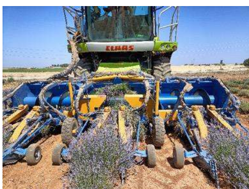
Imatge 21: Segadora-picadora que aboca la planta sobre un remolc destil·lador i detall de la planta picada. Foto: GPAM-CTFC
