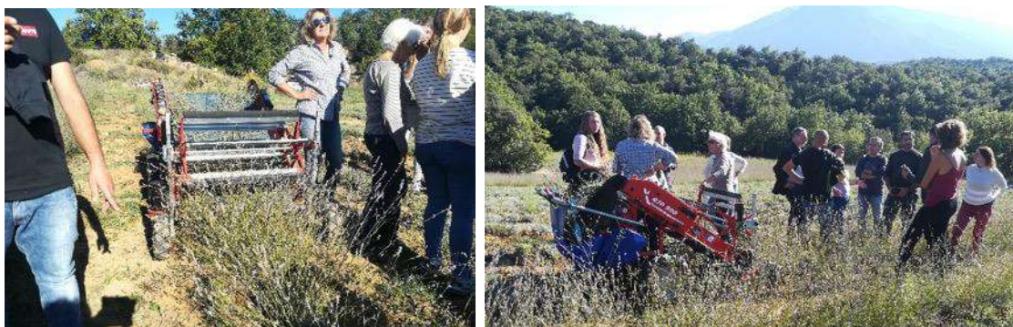
Imatge 18: collitadora manual autopropulsada Terrateck per a petites superfícies. Foto: GPAM-CTFC.
