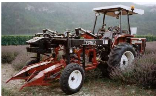
Imatge 19: recol·lectores en feixos (esquerra) i de planta sencera dreta de la marca Ponzo SARL. Foto: Ponzo-sarl.
