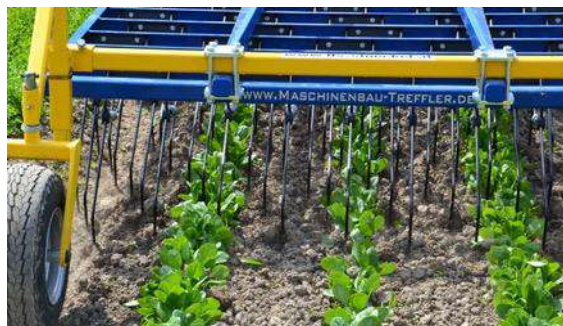
Imatge 7: Rastrell de pues flexibles Treffler. Font: https://auroraagricola.com/grada-de-puas-flexibles-treffler/
