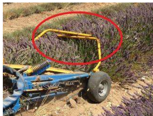
Imatge 23: estri "caçador d'abelles" inventat per CRIEPPAM + ADAP. Foto: https://www.fondation-capca.com/index.php/2018/08/01/le-kit-chasse-abeilles-un-dispositif-pour-eloigner-les-abeilles/
