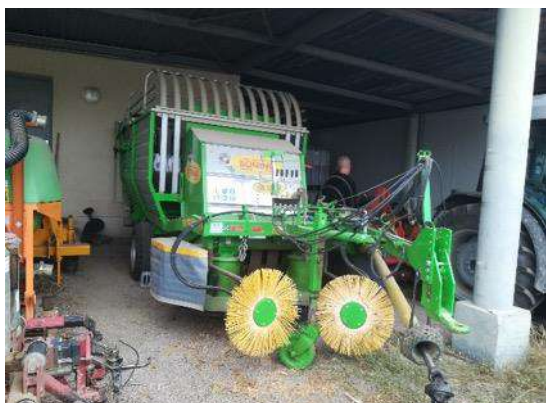
Imatge 22: segadora autocarregadora. Foto: GPAM-CTFC.
