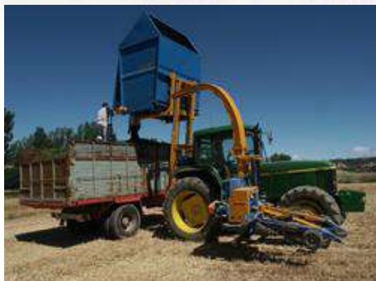
Imatge 20: Segadora-picadora amb remolc suspès darrere el tractor. Foto: GPAM (dreta a baix i a dalt), Clier (esquerra a baix, Chorras dreta a dalt).
