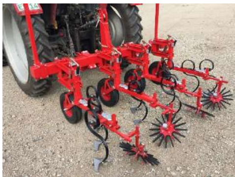
Imatge 25: Binadora de dits conserwa. Font: https://www.coserwa.com/fr/content/181/86/produits/desherbage-mecanique
