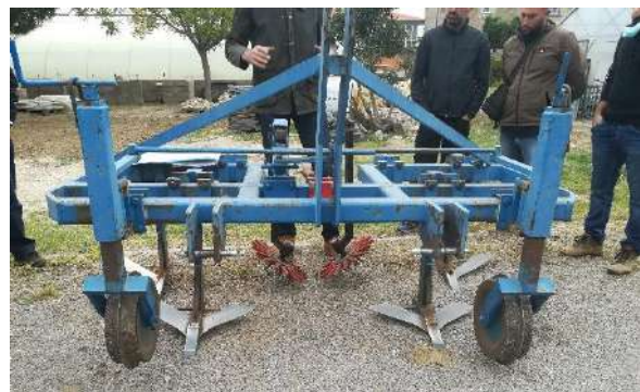
Imatge 26: Binadora amb rodes de dits utilitzada a l'escola agrícola de Rivesaltes (França). Font: GPAM-CTFC.
