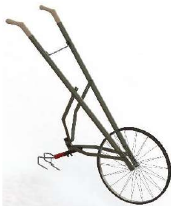
Imatge 21: aixada de roda simple. Font: UrbaPlant.
