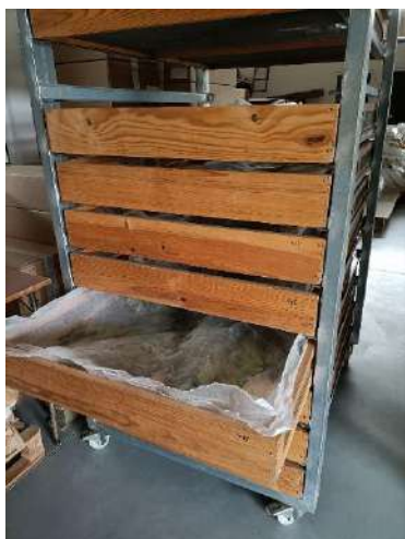
Imatges 42-43: assecadors estàtics amb lleixes. Font: GPAM-CTFC.
