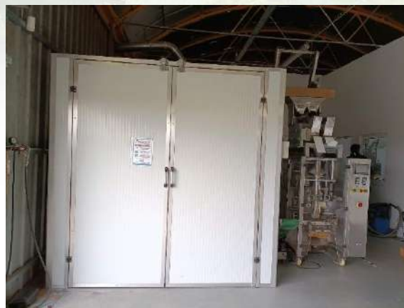
Imatges 40 i 41: assecadors forçats amb flux d'aire calent, dinàmic o en continuu el de l'esquerra i estàtic o tipus armari el de la dreta. Font: GPAM-CTFC.
