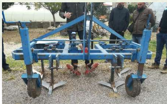
Imatge 27: Binadora amb rodes de dits utilitzada a l'escola agrícola de Rivesaltes (França). Font: GPAM-CTFC.
