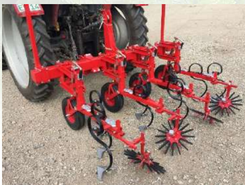
Imatge 26: Binadora de dits conserwa. Font: https://www.coserwa.com/fr/content/181/86/pr/oduits/desherbage-mecanique
