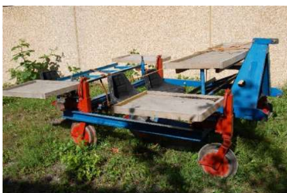
Imatges 20 i 21: Plantadores de tres cossos (FONT: GPAM-CTFC)
