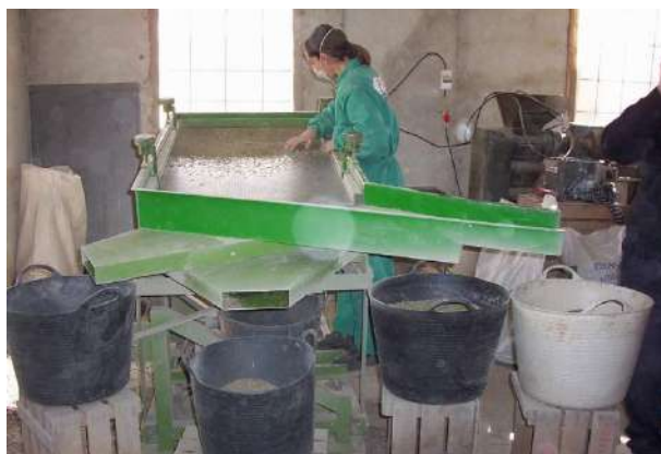
Imatges 44, 45 i 46: equipament per a processar la planta seca a la sortida de l'assecador. Tromels i taula gravimètrica. Font: GPAM-CTFC.
