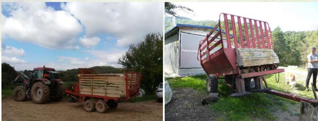
Imatges 36 i 37: Autocarregador de farratges adaptat i enganxat al tractor lateralment el de la dreta. Font: GPAM-CTFC.
