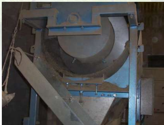
Imatges 44, 45 i 46: equipament per a processar la planta seca a la sortida de l'assecador. Tromels i taula gravimètrica. Font: GPAM-CTFC.
