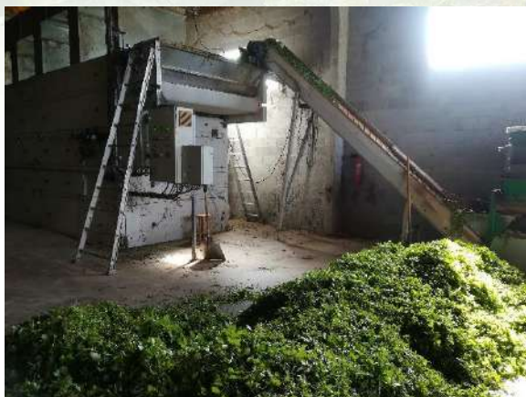
Imatges 40 i 41: assecadors forçats amb flux d'aire calent, dinàmic o en continuu el de l'esquerra i estàtic o tipus armari el de la dreta. Font: GPAM-CTFC.
