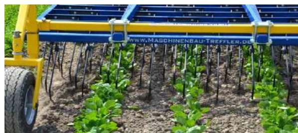
Imatge 25: Rastrell de pues flexibles Treffler. Font: https://auroraagricola.com/grada-de-puas-flexibles-treffler/
